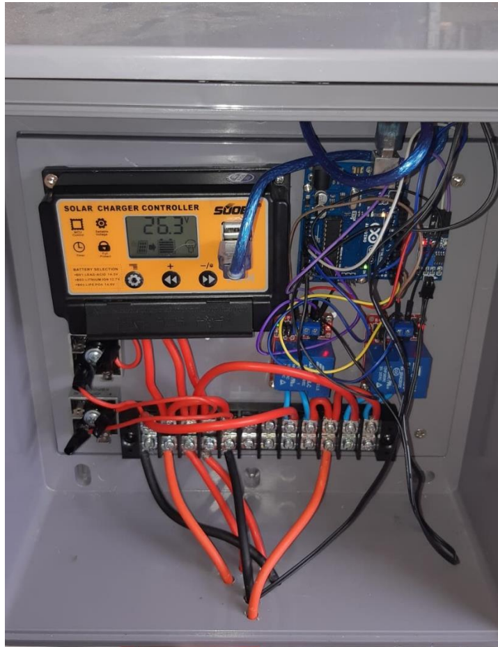
รูปที่ 1 ขั้นตอนที่1 เสียบสาย usb ของบอร์ด Arduino uno R3 เข้ากับ โซล่าชาร์จเจอร์
