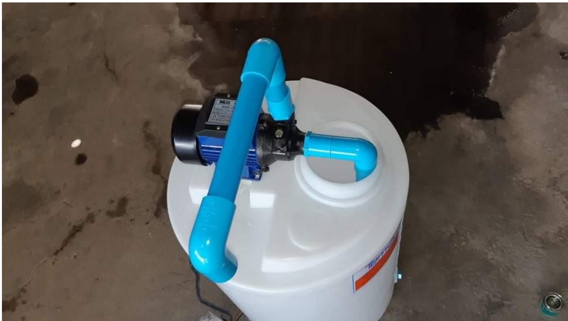
รูปที่ 3 ยึดถังน้ำกับปั้มน้ำ
