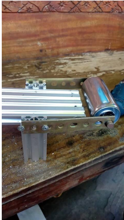
รูปที่ 5 ยึดเพลาลูกเข้ากับอลูมิเนียมโครงเพื่อใส่สายพาน
