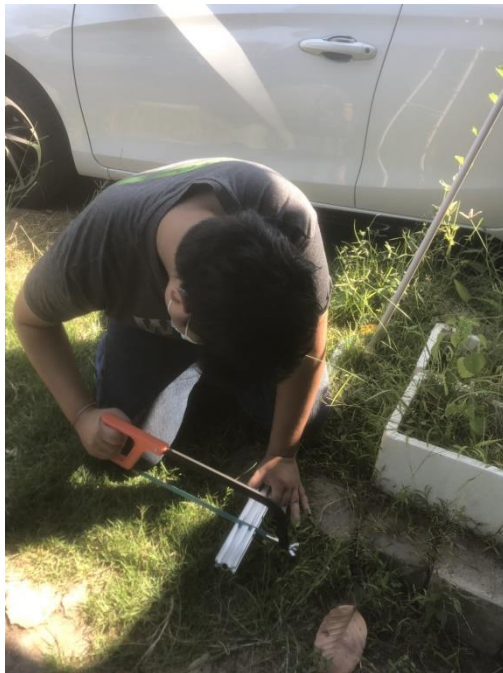
รูปที่ 1 ตัดอลูมิเนียมเพื่อทำโครงใส่สายพาน
