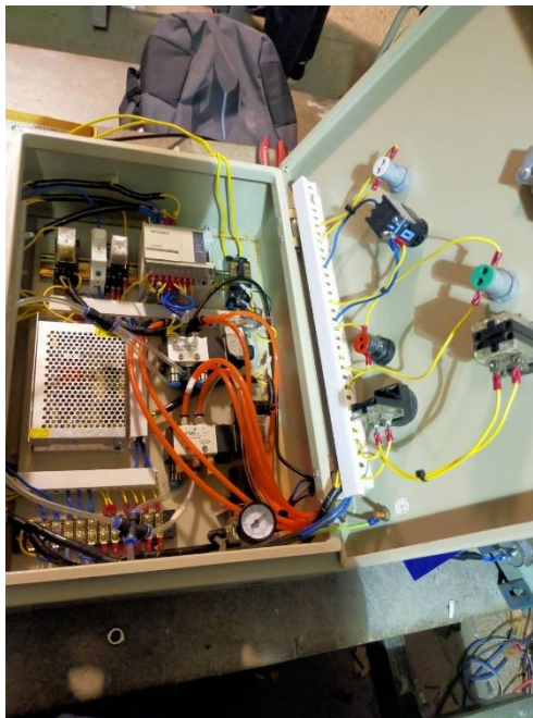
รูปที่ 12 ใส่สายลมและโหลดโปรแกรม PLC ลงไปเรียบร้อยแล้ว
