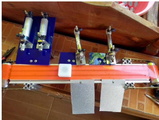
รูปที่ 5 ยึดเพลาลูกเข้ากับอลูมิเนียมโครงเพื่อใส่สายพาน
