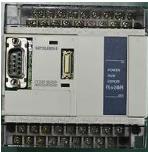
รูปที่ 2.1 แสดงรุ่น PLC (FX1N-24MR)
