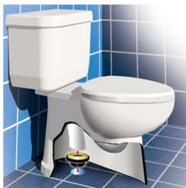
รูปที่ 7.121 ตรวจสอบท่อโครโครจากตัวสุขภัณฑ์ ให้ตรงกับท่อโครโครกับตัวอาคารก่อนยึด สุขภัณฑ์ให้มั่นคง
