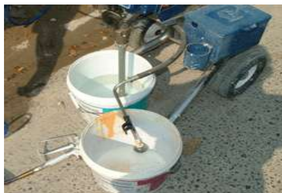
รูปที่ 7.100 เครื่องพ่นสีพร้อมอุปกรณ์และถังสี ที่จะใช้พ่น
