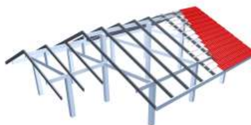
รูปที่ 7.128 โครงหลังคาเหล็ก
