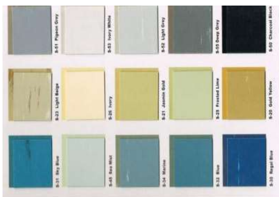
รูปที่ 7.17 ตัวอย่างแผ่นกระเบื้องยางให้ดูก่อนที่จะอนุญาตให้ทำงานต่อได้
