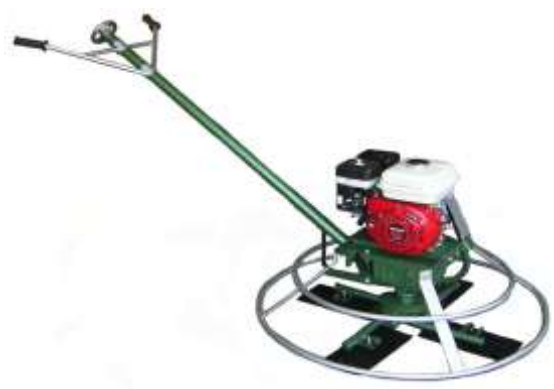
รูปที่ 7.32 เครื่องขัดประกอบอุปกรณ์ใบพัดขัด มัน
