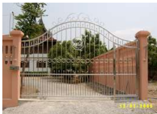
รูปที่ 6.10 ประตูรั้วสแตนเลสชนิดเปิด-ปิดโดยการเลื่อน มีบานสวิงเล็กสำหรับคนเข้า-ออกติดอยู่ในประตูบานใหญ่ด้านขวามือ
