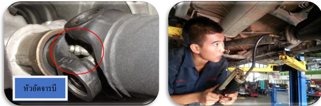
ภาพที่ 5.12 แสดงการหล่อลื่นข้อต่ออ่อนแบบกากบาท ด้วยจารบี
