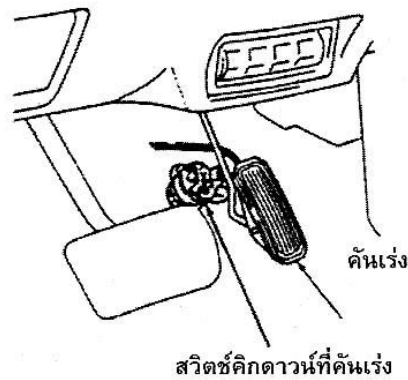
รูปที่ 6.14 แสดงสวิตช์คิกดาวน์ที่คันเร่งติดตั้งอยู่ที่ใต้คันเร่ง
