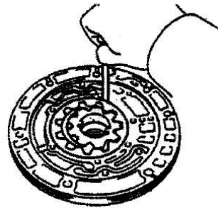
รูปที่ 13.17 แสดงการตรวจช่องว่างระหว่างเรือนปั้มและเฟืองตาม
