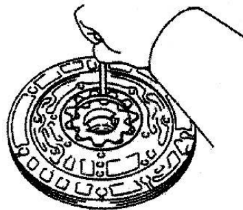
รูปที่ 13.18 แสดงการตรวจช่องว่างระหว่างเฟืองปั้มและเฟืองตาม
