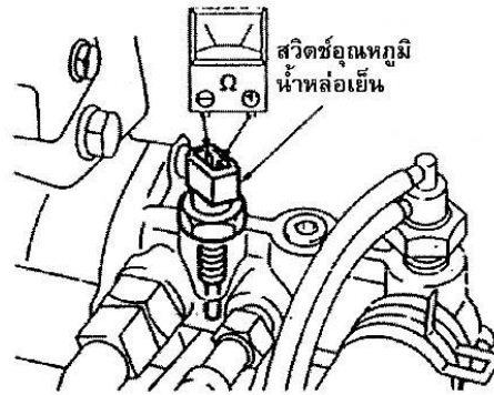
รูปที่ 14.5 แสดงการตรวจวัดความต้านทานสวิทช์อุณหภูมิน้ำหล่อเย็น
