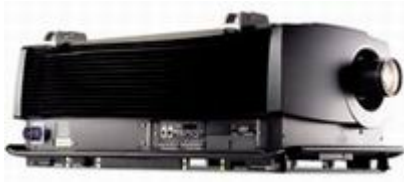
Digital Projection รุ่น LIGHTNING 28sx ให้ความสว่าง 16,000 ANSI และยังมีรุ่นLIGHTNING 35HD ให้ความสว่างที่ 20,000 ANSI Lumen ส่วนอายุของหลอดฉายทั้งสองรุ่นอยู่ที่ 750 ชั่วโมง
